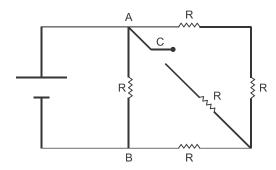
Com a chave C fechada, a resistência equivalente entre A e B passa a ser de
